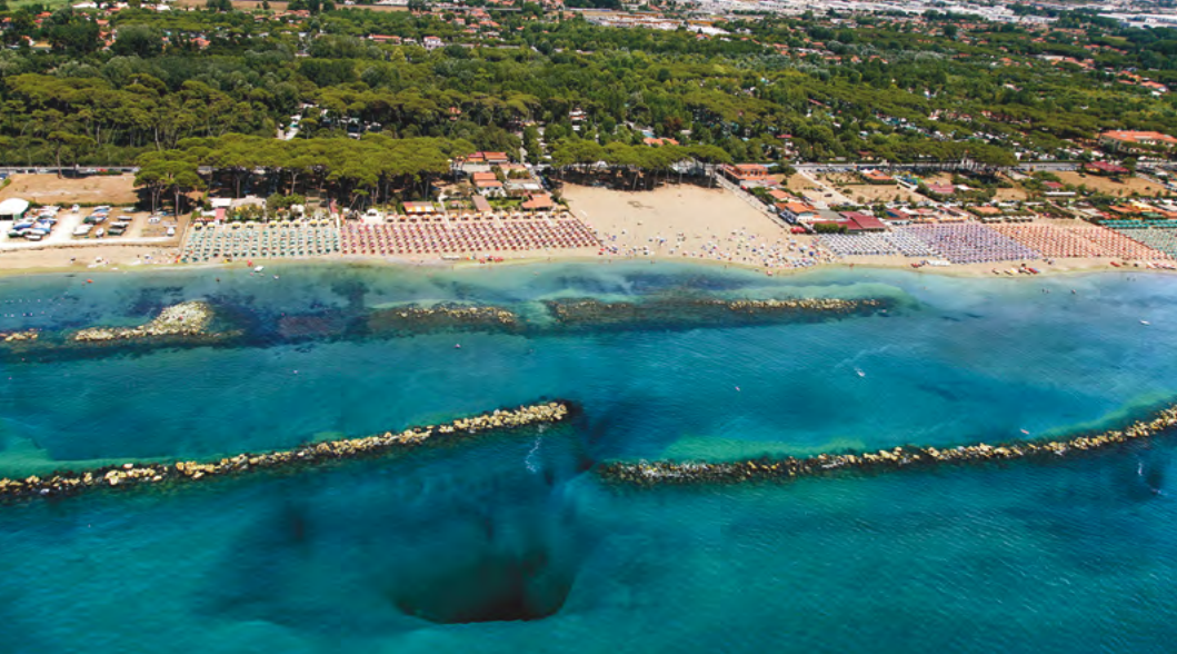
Fig. 20. Agujero excavado por la corriente de salida a través del espacio abierto entre los espigones paralelos (escala vertical exagerada) en Marina di Masa (Italia) (Image Geocoste s.r.l.)
